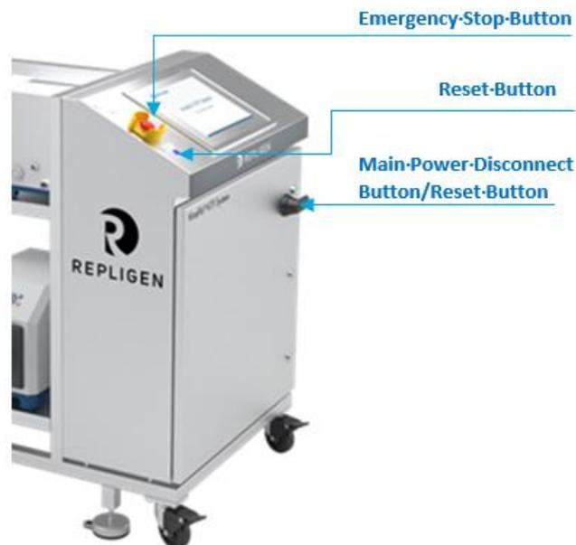
Das Drücken des Notausschalters stoppt alle Pumpen, setzt die Druckhalteventile auf 0 % (geschlossen) zurück und sendet einen Alarm. Die aktive Prozesssequenz wird in einem Wartestand versetzt.
