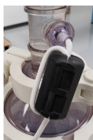
Figura 3. Manicotto in ferrite installato sul sensore di pressione del percorso del flusso
